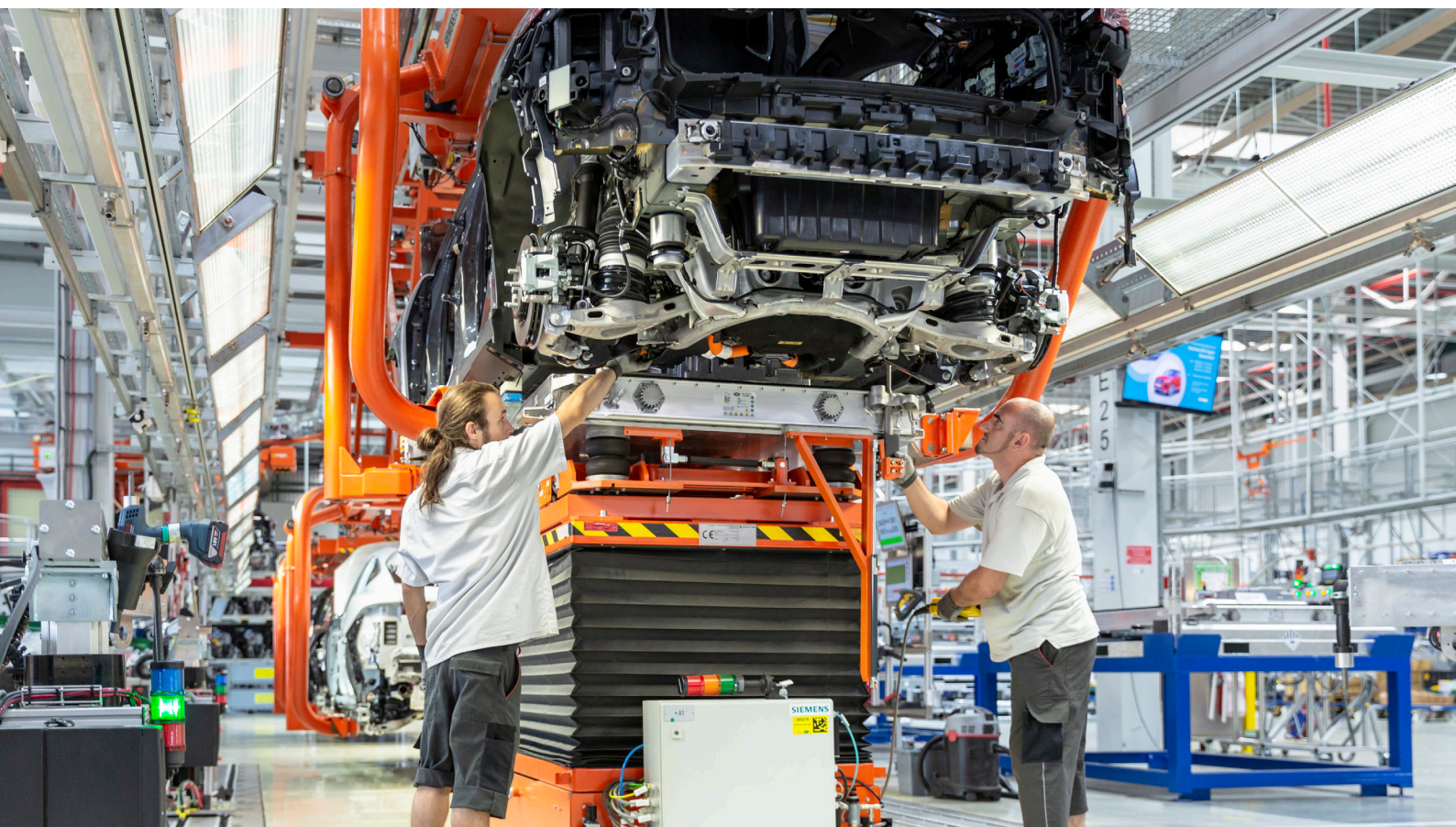
Als zukunftsorientierter Automobilzulieferer engagiert sich Magna auch stark im Bereich elektrischer Antriebe. So wird am Standort Graz etwa der Jaguar I-PACE gefertigt, das Foto zeigt den Einbau der Hochvolt-Batterie.
