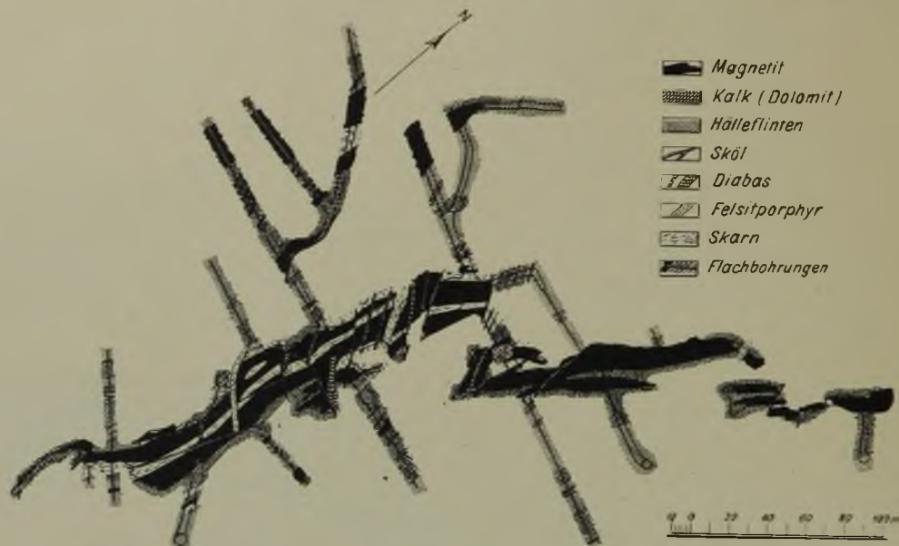
Abb. 6. Grundriß der 215 m-Sohle des Zentralfeldes von Dannemora.
