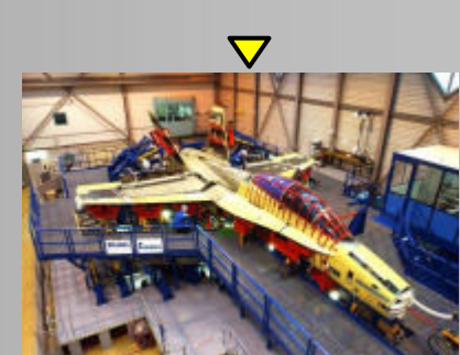
Ermüdungs- Grossversuch F-18C
