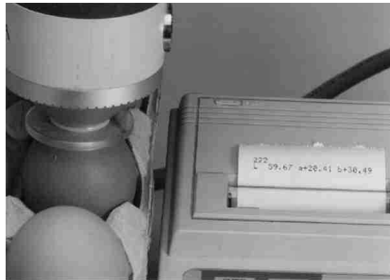
Abb. 3.3.7: Messung der Schalenfarbe mit dem Minoltagerät
