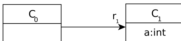
FIGURE 3.13 – Extrait d'un méta-modèle de 2 classes.
