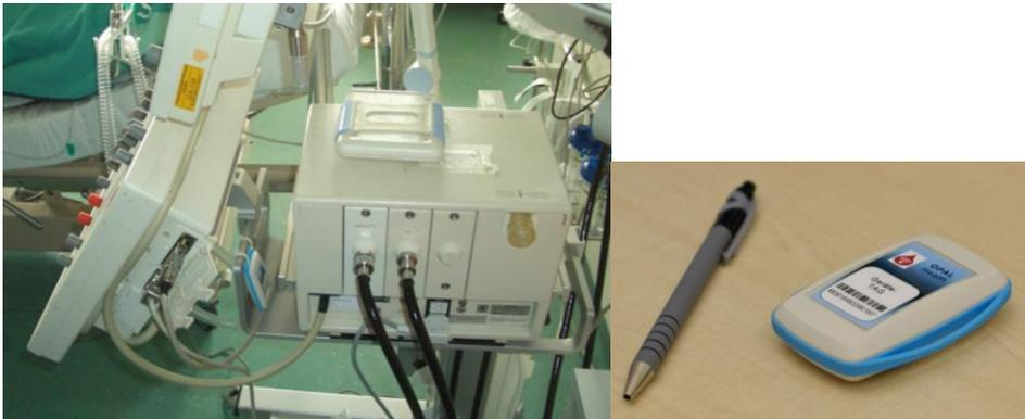
Abbildung 1: Sensorknoten und Anbringung an einem Beatmungsgerät
