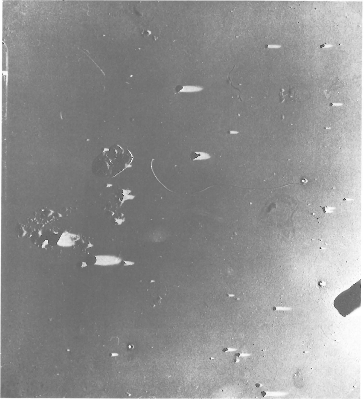
Abb. 4: Beispiel eines elektronenmikroskopischen Präparates submikroskopischer Trübung. Präparationstechnik: Nach Filtration (0,4 \mu ) 2 mal 120 min bei 900 Umdrehungen/min zentrifugiert; dazwischen Rückstand mit destilliertem Wasser 3 mal gewaschen. Mit Platinöse konzentriertes Präparat auf beschichtetes Objektträgernetz gebracht; getrocknet. Schrägbedampfung. Transmissionselektronenmikroskopie, Vergrößerung etwa 15000fach. Station: Süderpiep
