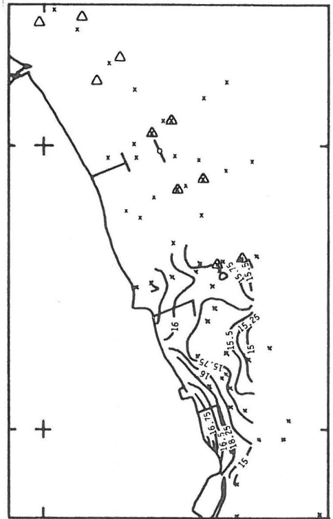
Isothermkarte aus Originalbilddaten 23/14 PH 6/7 11.59UHR x= Bodenmesspunkte Δ= Fahrinnenbegrenzung
